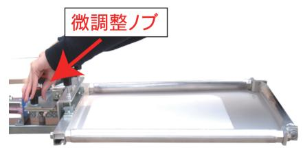
スクリーン枠を固定後、微調整ノブを緩めます。
